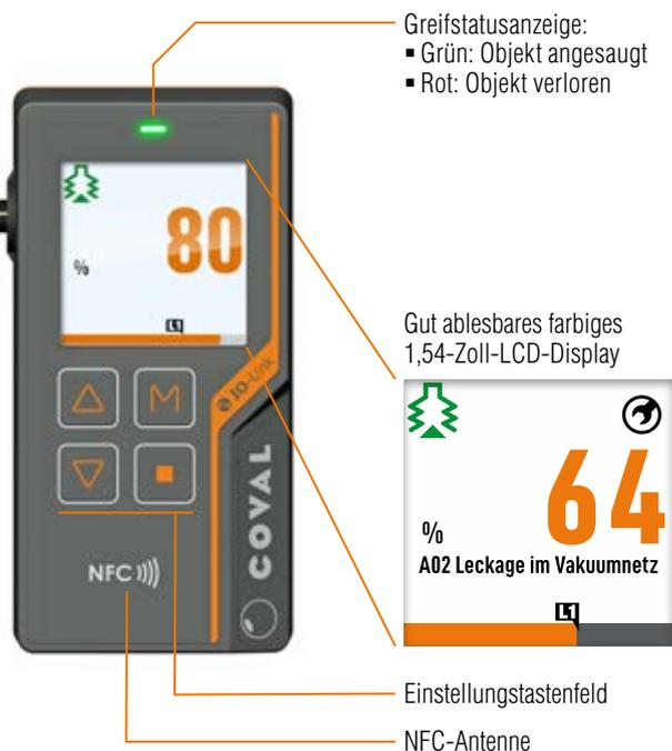
Die dezentrale MMS ermöglicht einfaches, effizientes Ablesen des Ejektorbetriebs.
