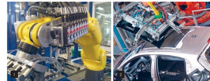
1 Zelle mit Mini-Vakuumpumpen LEMAX auf Roboter mit hohem Arbeitstakt.
