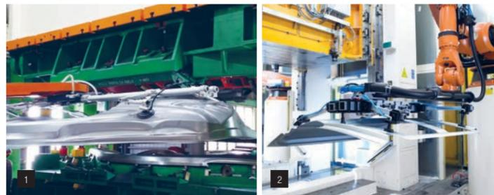
1 2 Vakuumpumpe LEMAX+ und Hochleistungs-Sauggreifer der Reihe C für das Greifen von Stanzteilen.
